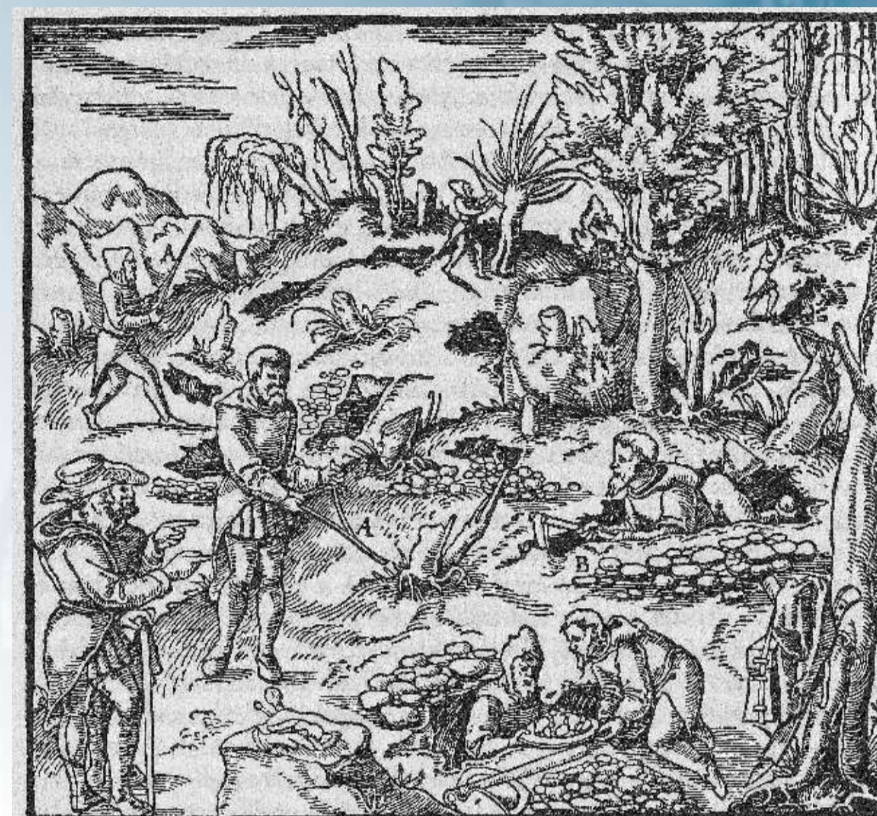
Telérek kutatása varázsvesszővel és kutatóárokkal A/ varázsvessző; B/ kutatóárok
